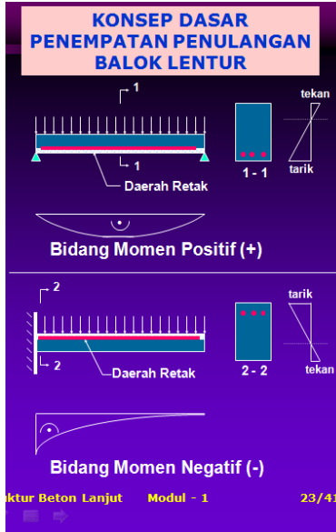
Gambar 1.8 Konsep Dasar Penempatan Penulangan Balok Lentur
