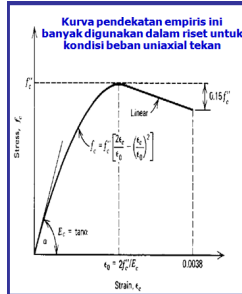
Gambar 1.3 Kurva Tegangan Regangan Beton Empiris
