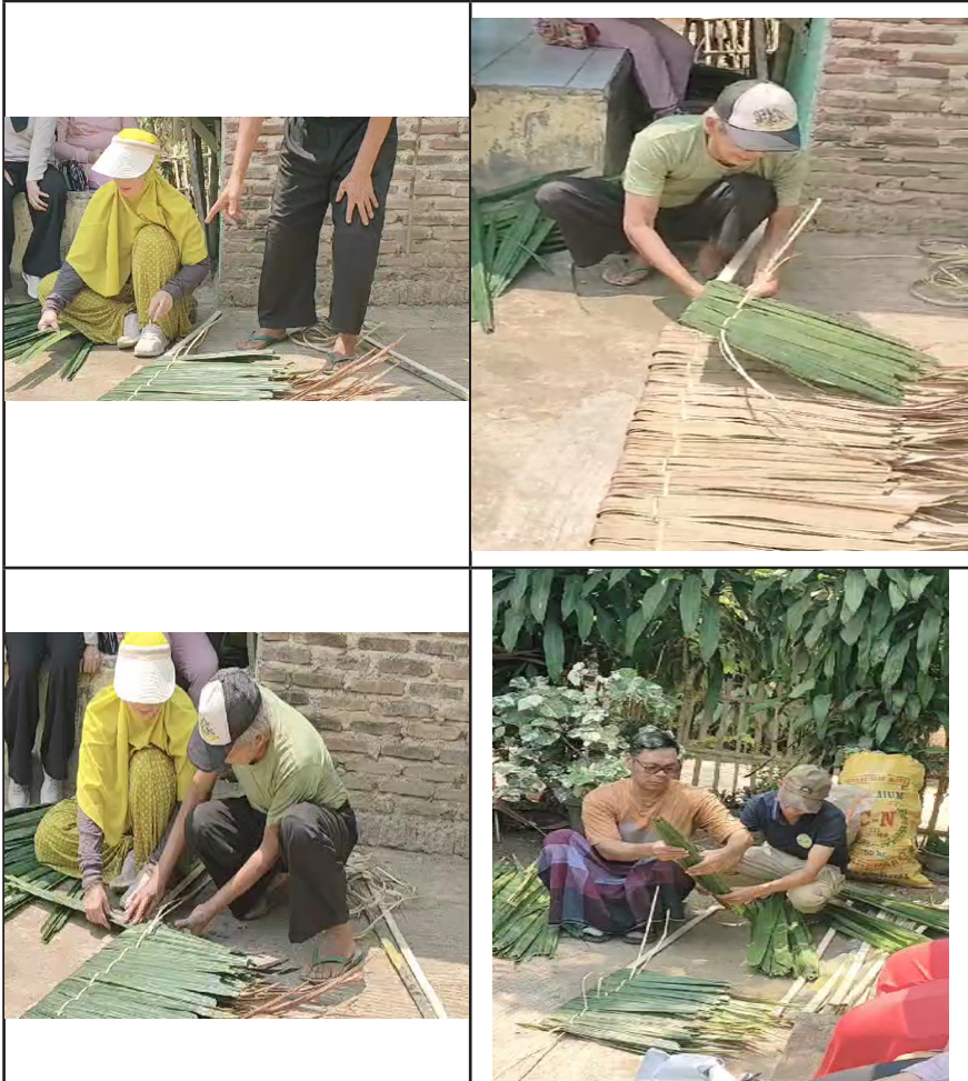
Gambar 3. Peserta abdimas, mencoba secara langsung praktek pembuatan atap rumbia.
