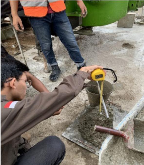
**Gambar 5.2** Penghitungan Nilai Slump
