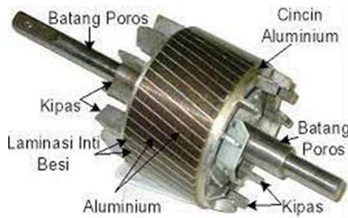
Gambar 5 Rotor Sangkar Tupai
